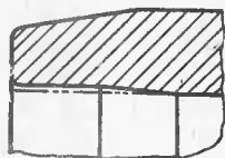
Рис. 25. Обработка носика бандажного кольца для установки изоляционной прокладки.
